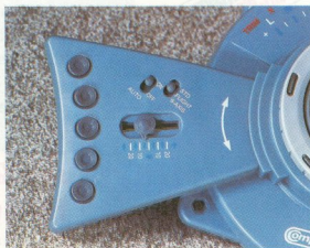
An der drehbaren Basis befinden sich fünf weitere Knöpfe, vier davon sind aber nur unter Windows 95 aktiv. Der Schubregler ist etwas klein geraten.
